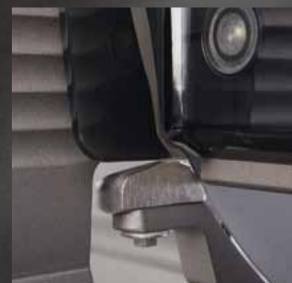
Nachstellbare Schneidgutstütze für präzise Schnitte · Adjustable product support for precise cuts
