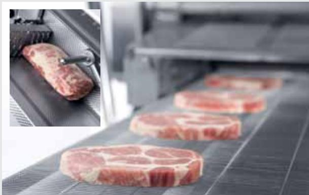
**Einzelscheibenverwiegung: jede Scheibe zwischen 50 und 300 g zielgewichtig geschnitten, die Abweichungen bei gleichförmigen oder leicht unförmigen Produkten liegen lediglich bei ca. 4 %. So reduziert sich das Give-away drastisch.**
